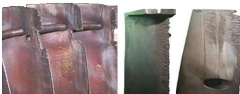
Рисунок 2. Примеры эрозийных повреждений лопаток паровых турбин
